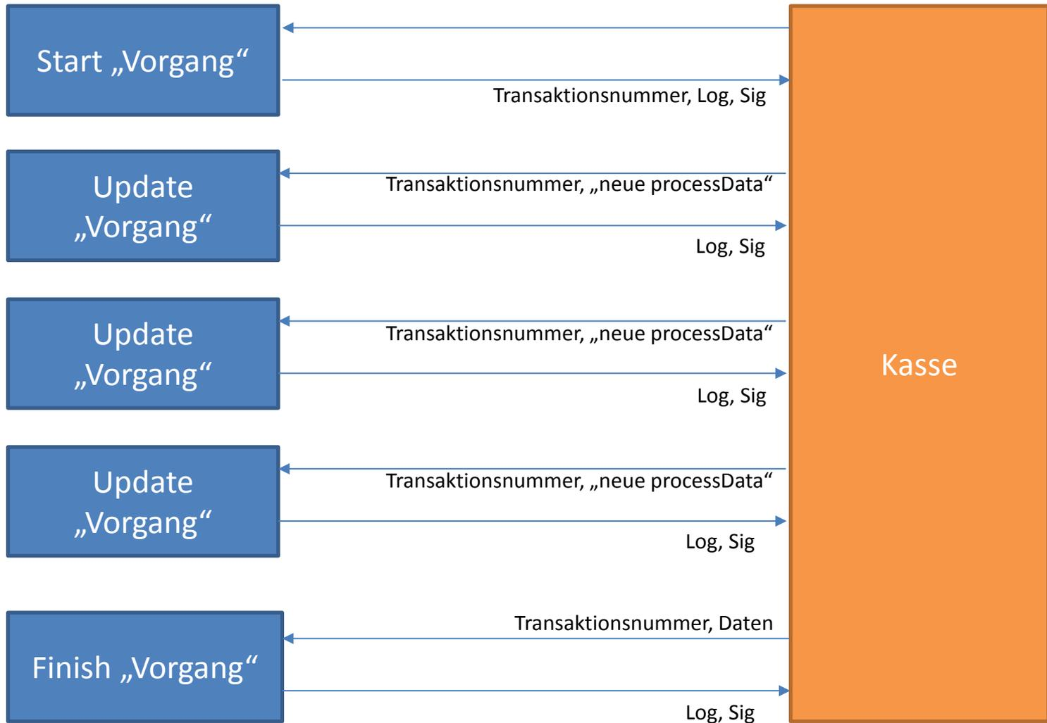
**TSE-Grundprinzip mit Festlegung processType/processData durch BMF
